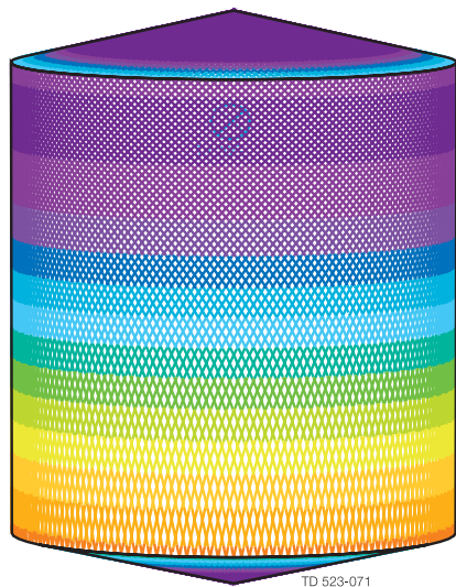
D4,6m H5,5m, Toftejorg TJ 20G, 4 x ø5,5 mm Tiempo = 8,3 min., Consumo de agua = 1.612 l (428 galones)
